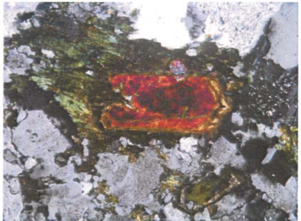
Fotomicrografia 4 – Cristal de allanita idiomórfico fraturado ao centro, em contato com biotita primária verde, quartzo e pequeno cristal arredondado de zircão acima. Lado maior da foto igual a 1,04mm. Polarizadores cruzados.
