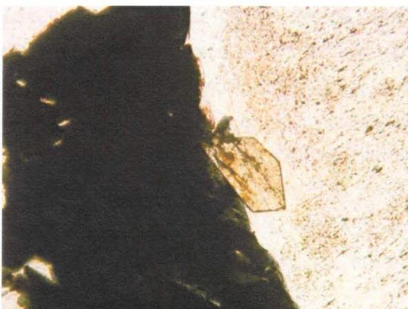
Fotomicrografia 18 – Cristal euédrico prismático de zircão incolor, translúcido, com poucas inclusões e fraturas, no contato entre mesopertita e riebeckita. Lado maior da foto igual a 0,65mm. Luz plano polarizada.
