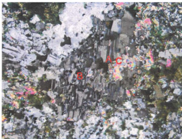
Fotomicrografia 10 – Plagioclásio (A) parcialmente substituído por albita (B) e micas (C).
