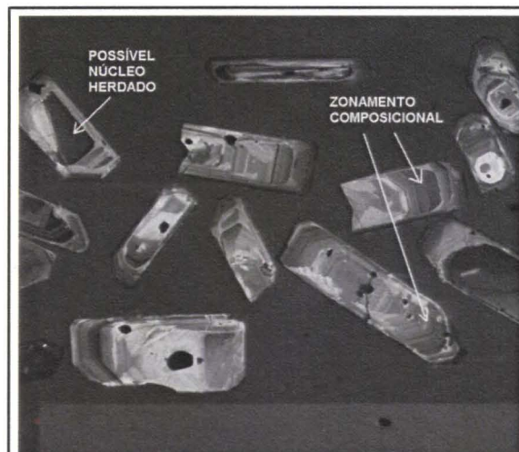
Imagem CL 1 – Cristais de zircão da amostra MAN-14, ilustrando diferentes morfologias de zonamento, inclusões e possível núcleo herdado. Lado maior da foto igual a 0,9mm.
