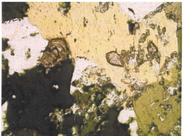
Fotomicrografia 6 – Cristais de zircão da geração A incluídos em cristal castanho claro de biotita (direita), e cristal idiomórfico de allanita (esquerda). Lado maior da foto igual a 1,30mm. Luz plano polarizada.
