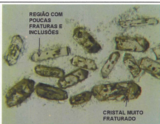
Imagem LT 1 – Cristais representativos da amostra MAN-14, ilustrando morfologias, micro-fraturamentos e inclusões diversas. Lado maior da foto igual a 1,13mm.
