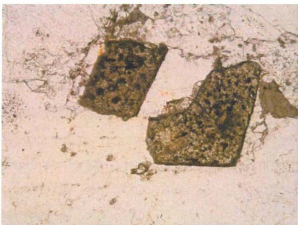
Fotomicrografia 17 – Cristais idiomórficos de zircão amarelos esverdeados, porosos, microfraturados. Lado maior da foto igual a 0,81mm. Luz plano polarizada.
